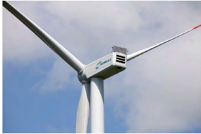
Figure 87. Nacelle de l'éolienne N131
